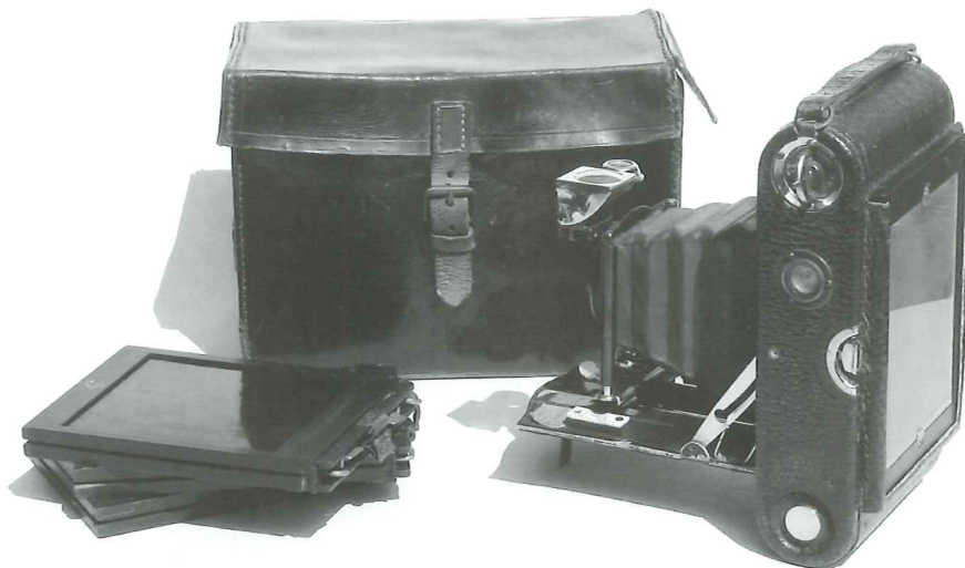
No. 3 FPK uitrusting van bescheiden kwaliteit voor de 'serieuze' amateur. Hier voorzien van combination back met matglas.
