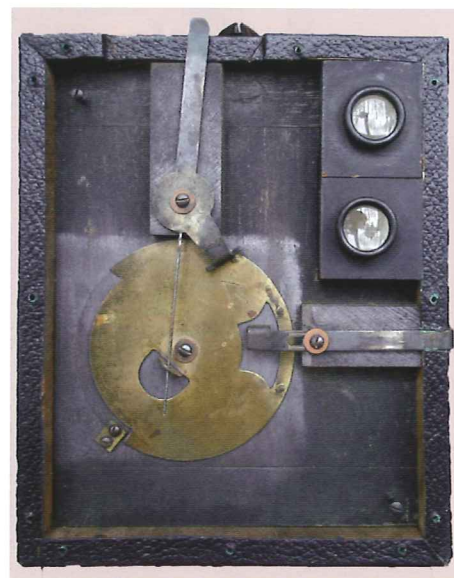
Na het losschroeven van de voorzijde komt de eenvoudige roterende sluiters tevoorschijn.
