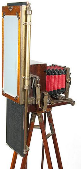
21 Miethe driekleurencamera uit de collectie van Scott Bilotta. De wisselslede is in de foto's voorzien van het matglas. Dit kan vervangen worden door een dubbele plaathouder. De wisselslede bevindt zich in de hoogste positie. De plank waarover de slede beweegt, zorgt ervoor dat er geen ongewenst licht op de lichtgevoelige glasplaat kan vallen. De buis aan de rechterkant van de slede is de pneumatische rem. Met dank aan Scott Bilotta voor het ter beschikking stellen van de foto's.
