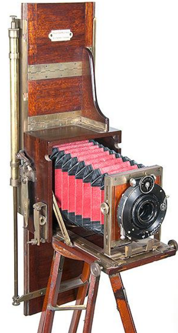
20 Boven en onder de camera steekt de achterwand uit waarover de slede met de plaathouder beweegt. De plank is verdeeld in scharnierende segmenten en kan worden samengeklapt voor transport.
