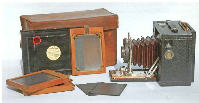
No. 3 Cartridge Kodak met toebehoren. Het toestel is voorzien van de glasplaatachterwand en een plaathouder is er in geschoven. Tegen de tas de rolfilmachterwand en het matglas. Op de voorgrond dubbele plaathouders en drie houders voor vlakfilm.
