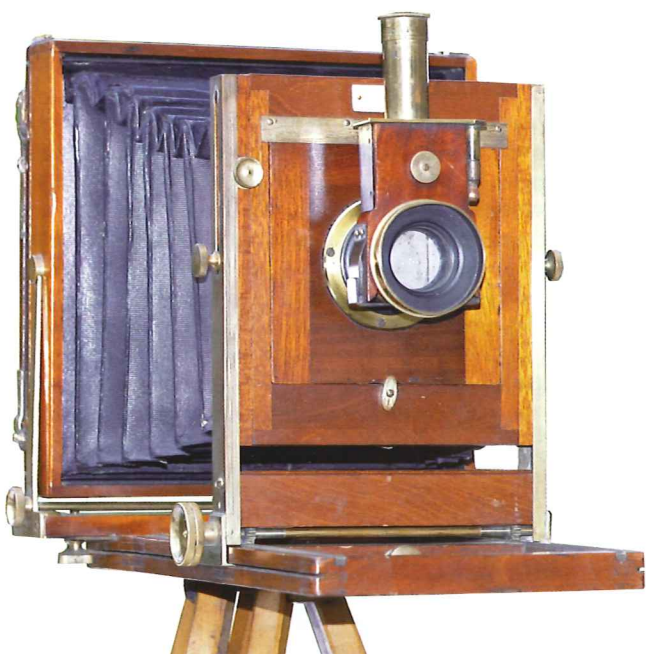
Eastman Interchangeable View camera, formaat 5 x 8 inch. Objectief en sluiters moesten apart worden aangeschaft. Dit exemplaar is voorzien van een bij elkaar passend stel van A. Laverne uit Parijs.
