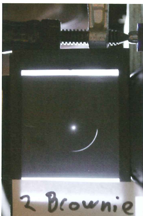
Testopname om de sluitertijd van een No. 2 Brownie te meten. Een lampje op een snel draaiende schijf (circa vijf omwentelingen per seconde) trekt een spoor op het matglas gedurende de tijd dat de sluiter geopend is.
